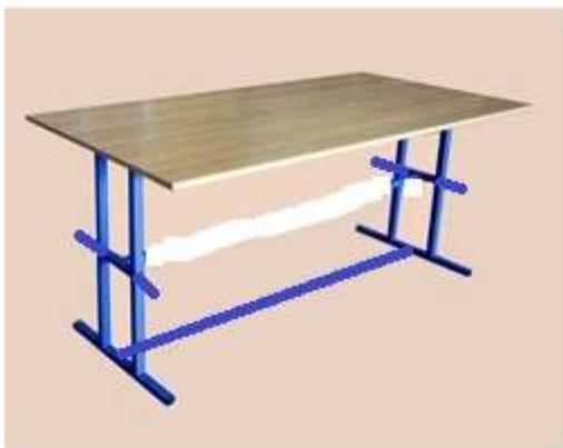
Материал : металл (каркас из прямоугольной трубы), краска -эмаль. ЛДСП, Кант ПВХ 2мм. Столешница выполнена из ламинированной столешницы 28 мм, торцы столешницы обрамлены кантом ПВХ 2 мм. Сборка щитовых элементов производится с помощью винтов - гаек мебельных. Боковые стенки имеют полимерные не регулируемые
